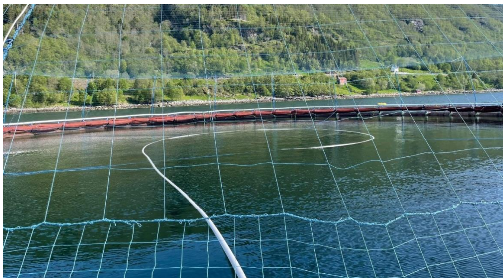
Figur 4 Perforert fôrslange rigget i merd. Bildet er fra lokalitet Forså i Ibestad kommune (KIME Akva AS).
