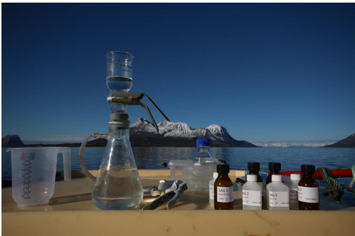
Figur 15. Bildet viser filtrering av vannprøver til analyse av klorofyll a i Sagfjorden. Foto: Geir Dahl-Hansen
