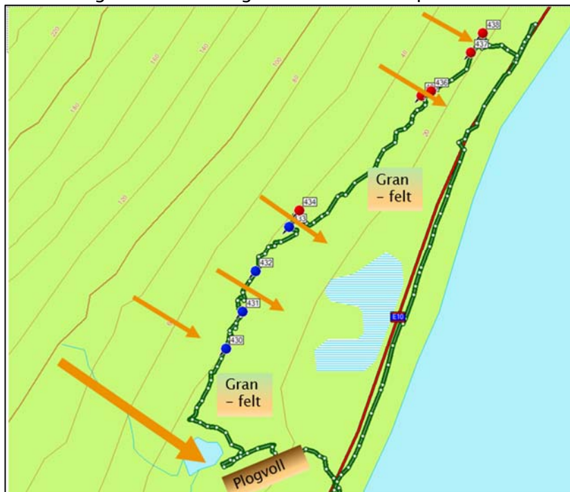
Figur 7: Eksempel på feltregistreringer av skredløp med Garmin GPS, på Lille Våtvoll, området nord for dagens plogvoll, skissert på kartgrunnlag fra Topo Pro. Pil betyr ett skredløp.
