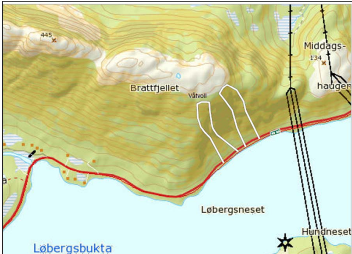
Figur 24: Omr. 3C: Løbergssneset. Skredløp snøskred fra Brattfjellet skissert med antatte løsneområder. Fra Beredskapsplan naturfare Vesterålen, utg. 2014-15, topografisk kart v/Silje S. Haaland.
