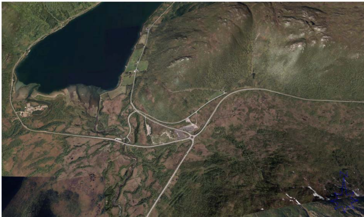
Figur 14: Gullsfjordbotn, Lofastkrysset og Austerdalen (til høyre). Vegtrasé gjennom åpent myrlandskap der vegen kan være utsatt for drivsnø og snøfokk. Grunnlag. norgei3d.no.
